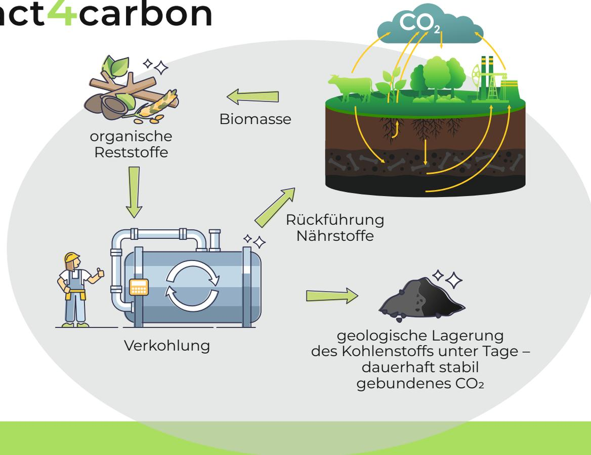
Mit Hilfe von Prozessen wie **Pyrolyse und Hydrothormaler Carbonisierung (HTC)** kann Biomasse (wie z. B. Grünschnitt, Biomüll, Gülle, Mist oder auch Klärschlämme) in Biokohle umgewandelt werden.
